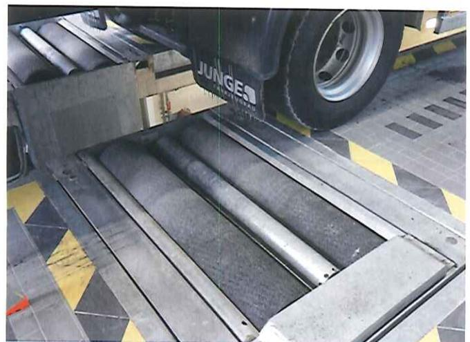
Der Bremsenprüfstand weist Überbreite auf, um auch Sonderfahrzeuge wie Autokrane prüfen zu können.
